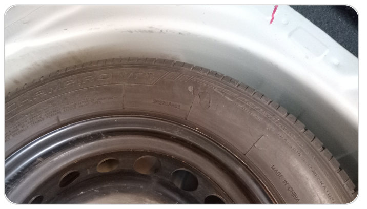
حالة الكاوتش الاستين : تشققات/قطع بسيط
