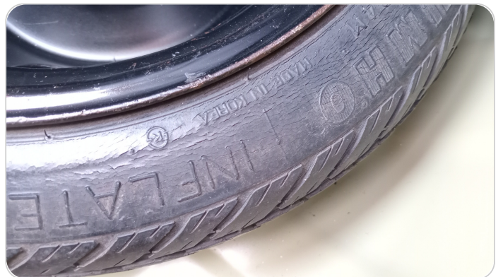
حالة الكاوتش الاستين : تشققات/قطع بسيط
