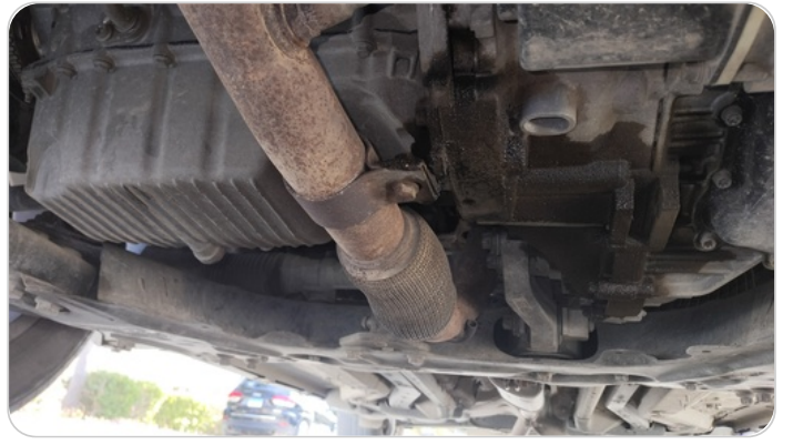
المحرك : اثار تسريبات زيت جهة اويل سيل كرنك خلفي
