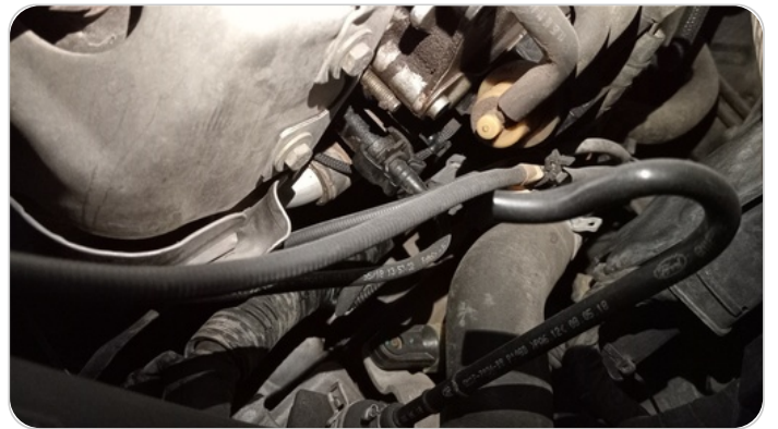
المحرك : تسريب زيت جهة غطاء تكهات المحرك
